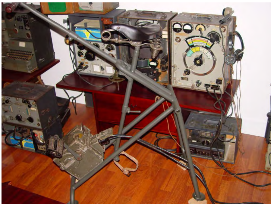
3. ábra. TM5 típusú német pedál-generátor (forrás: www.wehrmacht-awards.com )
