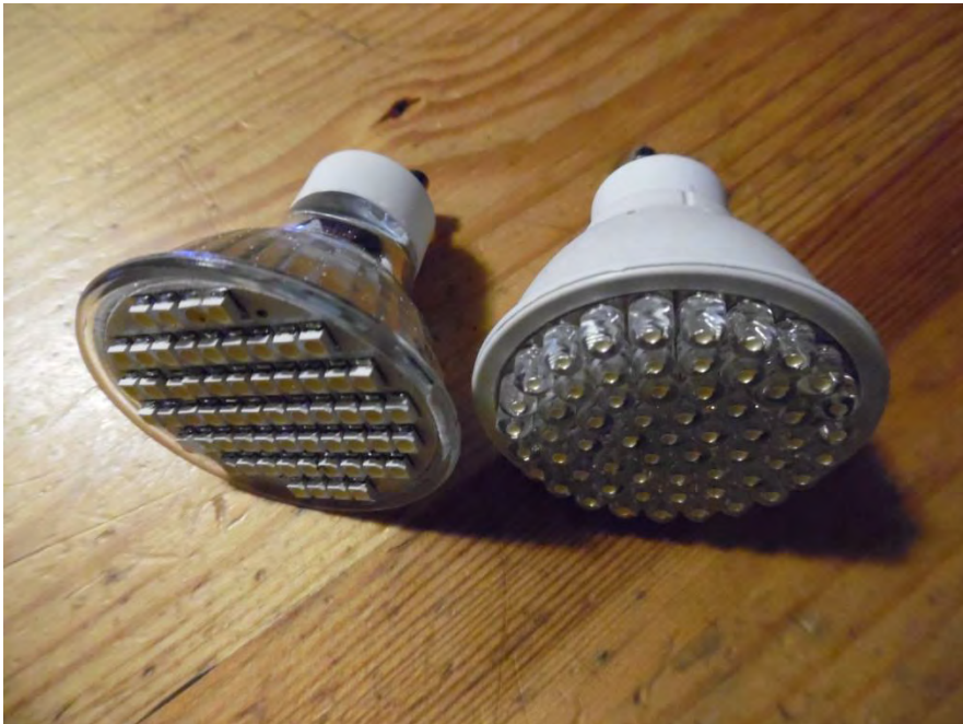
4. ábra. Egy SMD-technológiás és egy diszkrét diódákból felépített GU-10-es fényforrás
