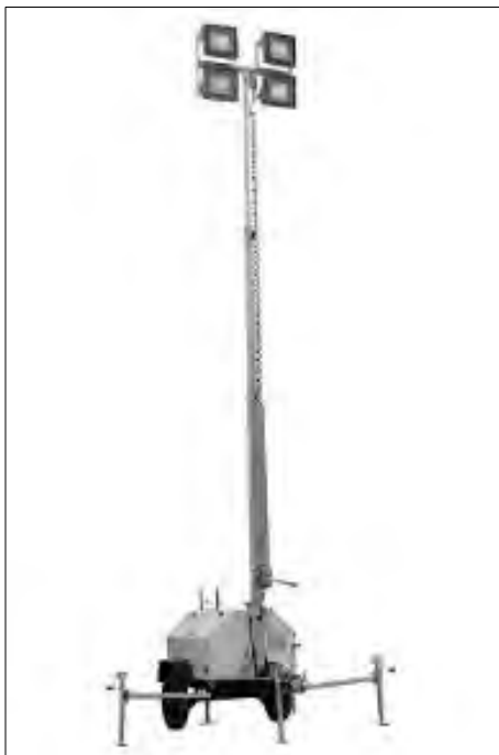
10. ábra. Teleszkópos tornyon elhelyezett 4x150W teljesítményű (kb. 50 000 lumen) LED-es lámpa, saját aggregátorral az utánfutóján (forrás: http://www.larsonelectronics.com )
