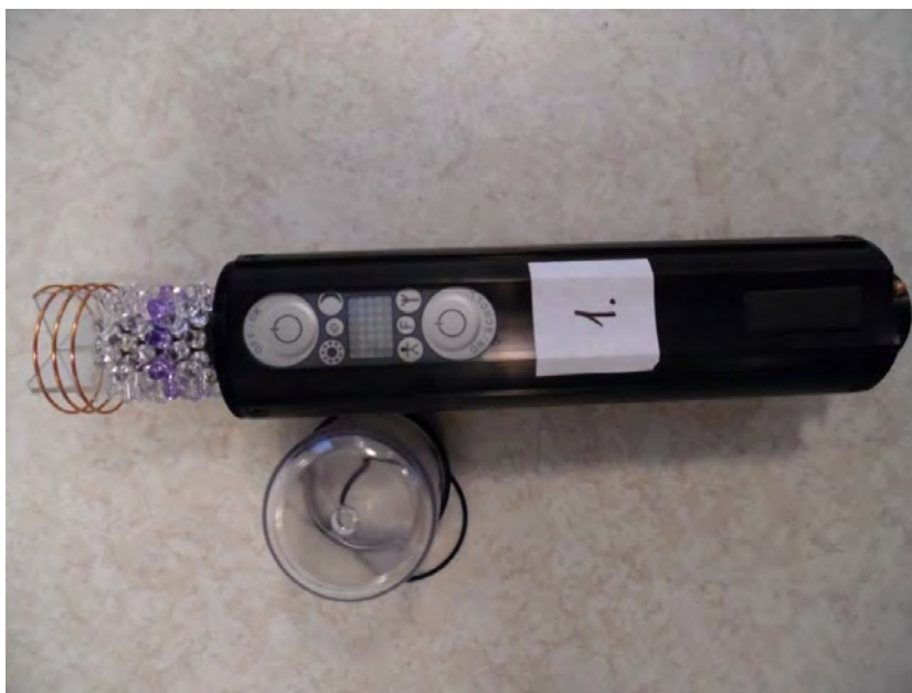
13. ábra. Egy fényelem leszerelt üvegburával. Az alumíniumház 80%-át az akkumulátor foglalja el. A több eltérő szín miatt a LED-csoport diszkrét fénydiódákból van felépítve. Legfelül található a rádióvezérlés vevőantennája
