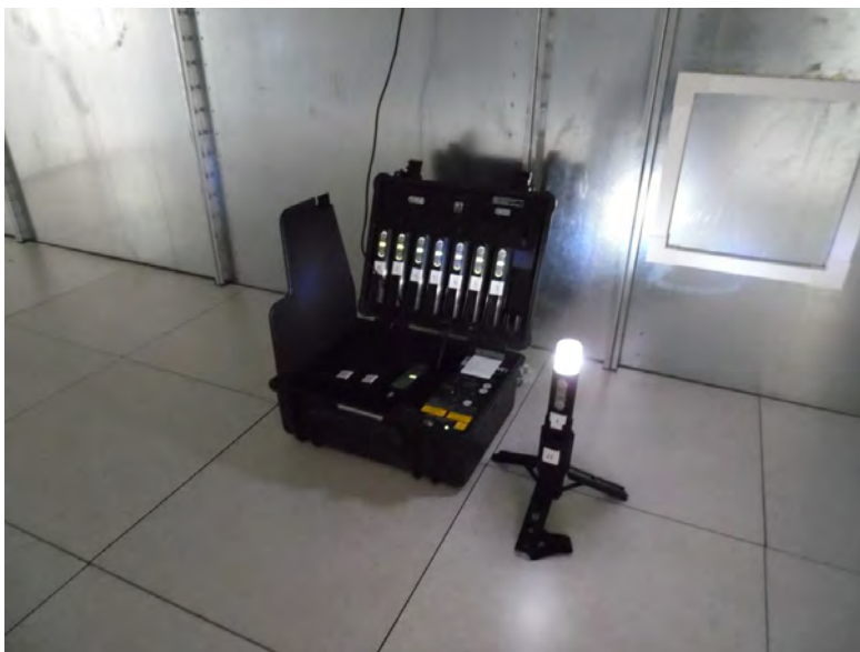
12. ábra. A TALKIT teljes készlete a bőröndben töltődik, egy fényelem kiemelve, a saját tripodján önállóan működtetve
