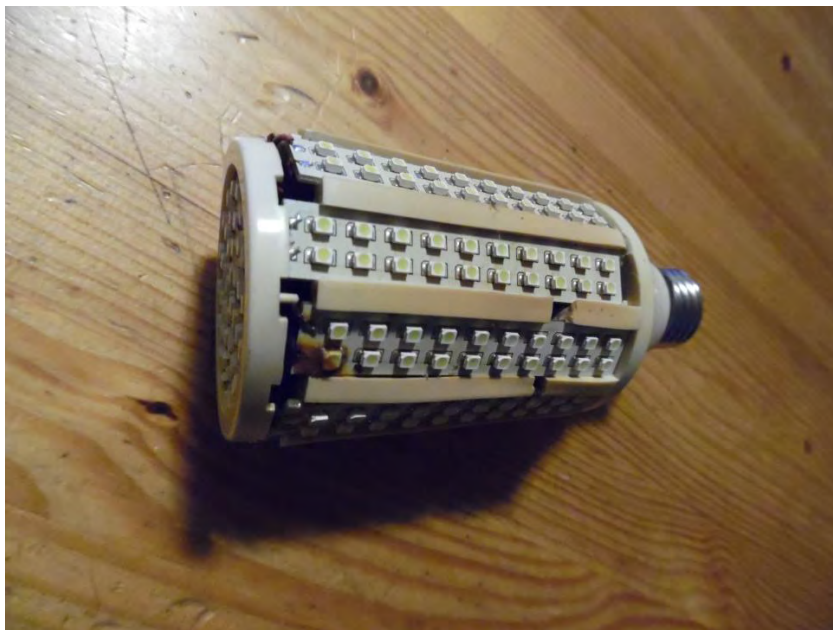
6. ábra. A hőelvezetés hiánya miatt megégett E27-es "kukorica" LED-lámpa
